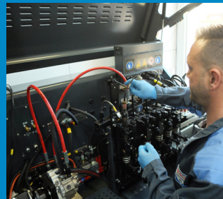
Kolejnym etapem jest sprawdzenie działania wtryskiwaczy na tzw. stole probierczym.
