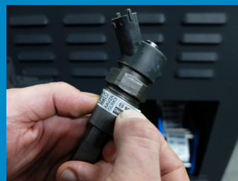
Jeśli wtryskiwacz pozytywnie przejdzie próby, autoryzowany serwis Bosch nadaje mu etykietę Bosch QualityScan.
