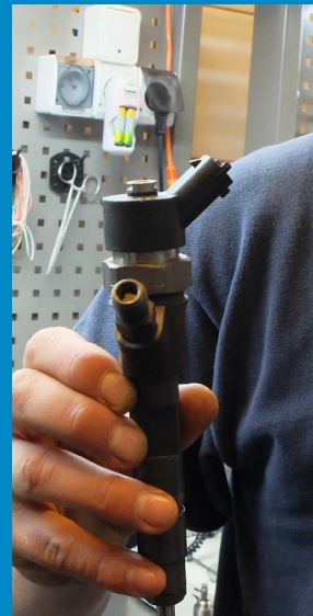
Po zmontowaniu wtryskiwacz nie trafia jeszcze do klienta – część musi zostać przebadana.
