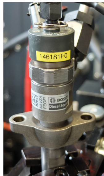
Drożej, ale bezpiecznie: fachowo odnowiony wtryskiwacz z etykietą Bosch QualityScan i nadanym kodem IMA.
