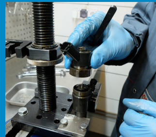
Jeśli wstępne badanie wykazuje jakiegokolwiek usterki, wtryskiwacz jest rozmontowywany na części.
