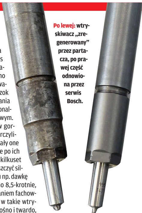
Poza wymianą uszkodzonych części podczas regeneracji regulowane są także parametry jak m.in. siła naciśnięcia sprężyny zaworu, wielkość szczeliny powietrznej i skok kulki zaworu, siła naciśnięcia sprężyny rozpylacza czy skok igły rozpylacza. Jakiegokolwiek pomyłki wychodzą podczas badania na stanowisku probierczym.
